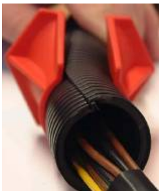
Der Wellschlauch verschliesst sich durch das Herunterdrücken der einen Wellschlauchseite und das gleichzeitige „Einhaken“ in den Verschliessmecha- nismus. The Corrugated tube locks itself by being pressed down on one side and at the same time being „hooked“ into the lock mechanism.
