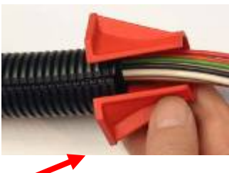
Vordere Kante der Schliesswerkzeugs direkt auf der Verschliessnaht des Wellschlauchs platzieren. Place front edge of the Closing tool directly on the fastening seam of the corrugated tube.
