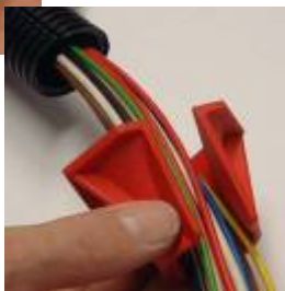
Vordere Kante der Schliesswerkzeugs direkt auf der Verschliessnaht des Wellschlauchs platzieren. Place front edge of the Closing tool directly on the fastening seam of the corrugated tube.
