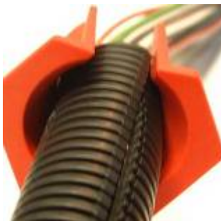
Schliesswerkzeug über den Wellschlauch schieben. Slide Closing tool over the Corrugated tube.
